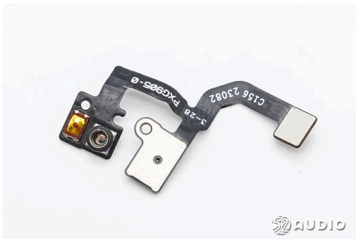
麦克风、气压计和功能按键模组一侧电路一览。
