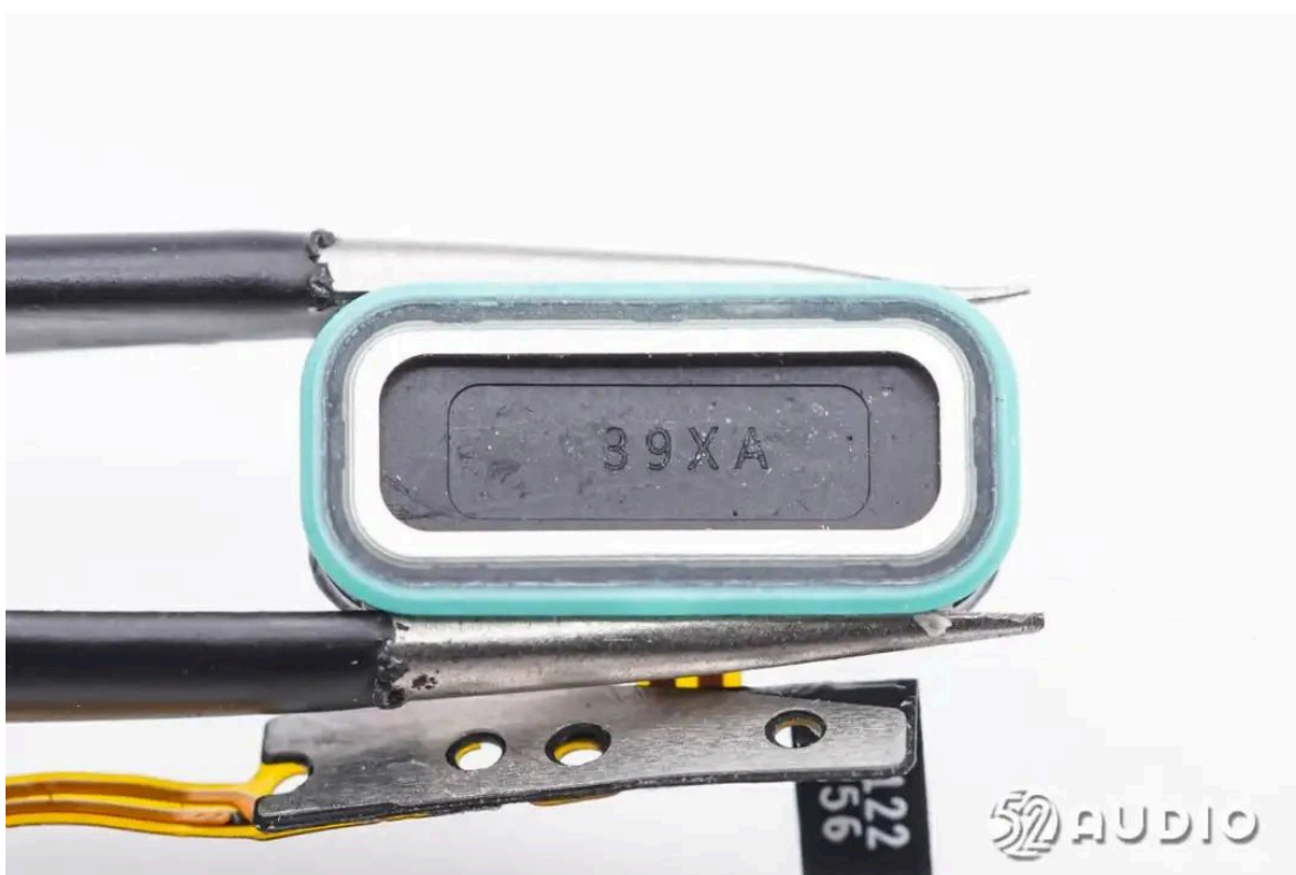
扬声器正面振膜特写，外围设置有密封胶圈防水。
