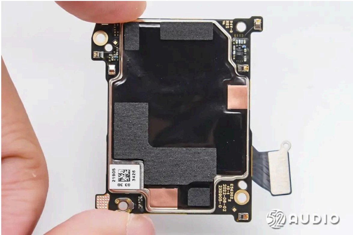
主板一侧特写，通过大量屏蔽罩防护，贴有散热贴纸。
