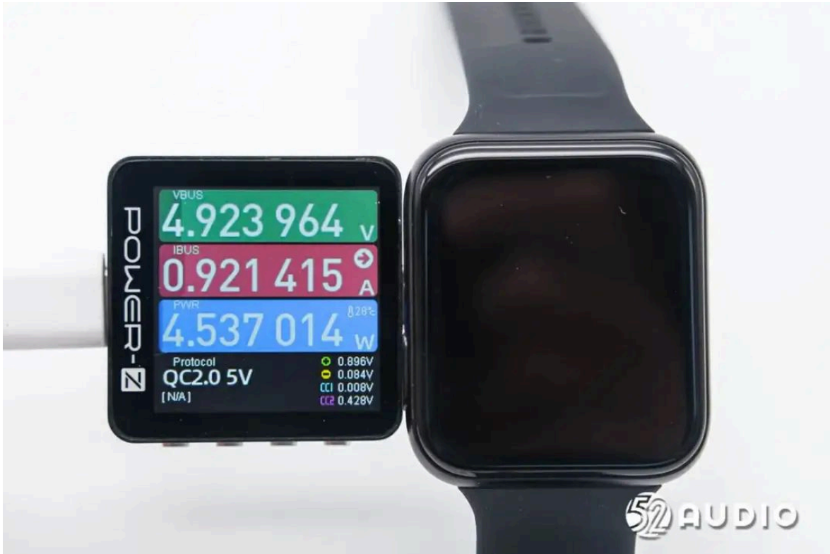
智研所采用CHARGERLAB POWER-Z KM003C对OPPO Watch 3智能手表进行充电测试，输入功率约为4.54W。
