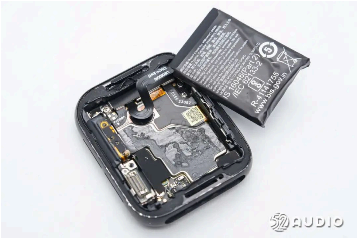
掀开表盘内部的电池单元，下方电池排线通过BTB连接器连接主板，通过金属压板固定。
