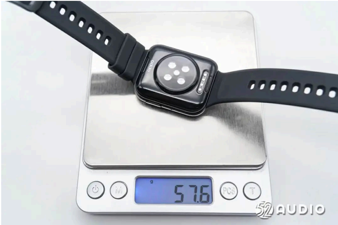
经智研所实测，表盘搭配氟橡胶表带，整机重量约为57.6g。
