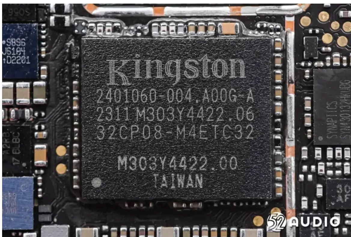
Kingston金士顿32CP08-M4RTC32的存储器，下方焊接Qualcomm高通骁龙W5可穿戴芯片。
