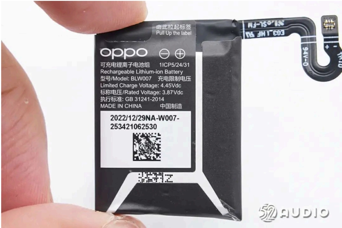
手表内置可充电锂离子电池组，型号：BLW007，充电限制电压：4.45V，标称电压：3.87V，中国制造。
