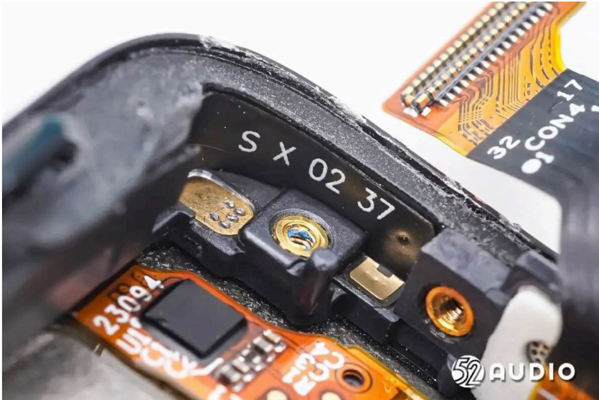
中框上的蓝牙天线特写，漏铜连接主板。
