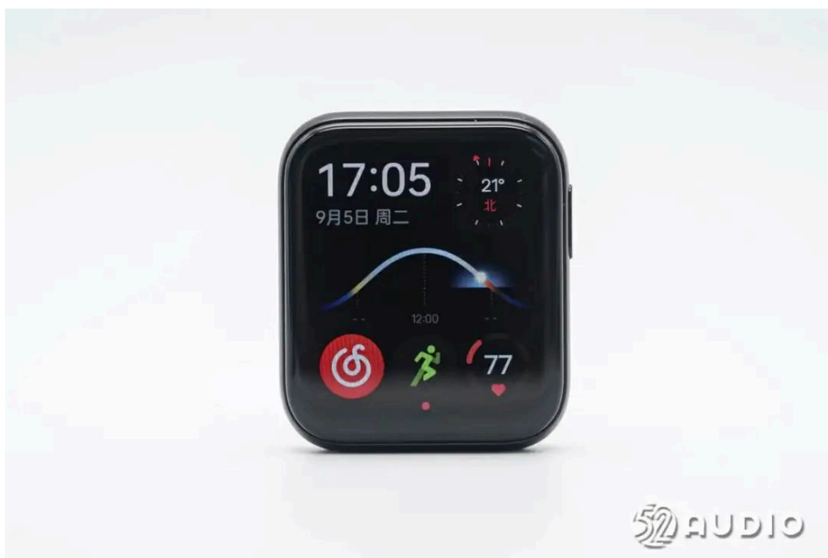
OPPO Watch 3表盘正面外观一览，采用了3D玻璃盖板，4边曲边，1.75英寸AMOLED屏幕，色彩观感鲜艳细腻，触控滑动流畅。
