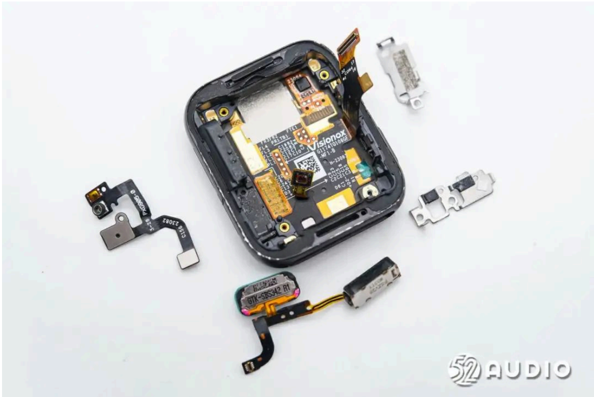
卸掉螺丝和金属支架，取掉中框上的元器件。
