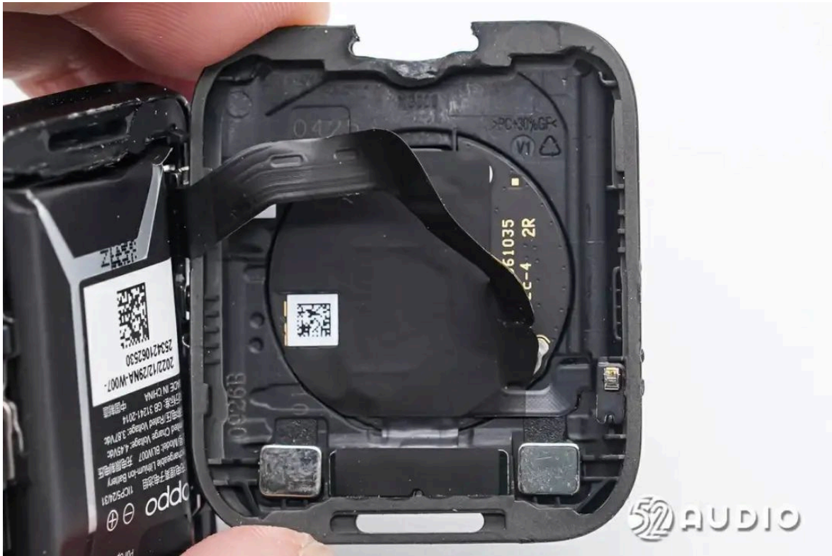
盖板内侧结构一览，设置圆形传感器模组小板，背部贴有NFC天线。
