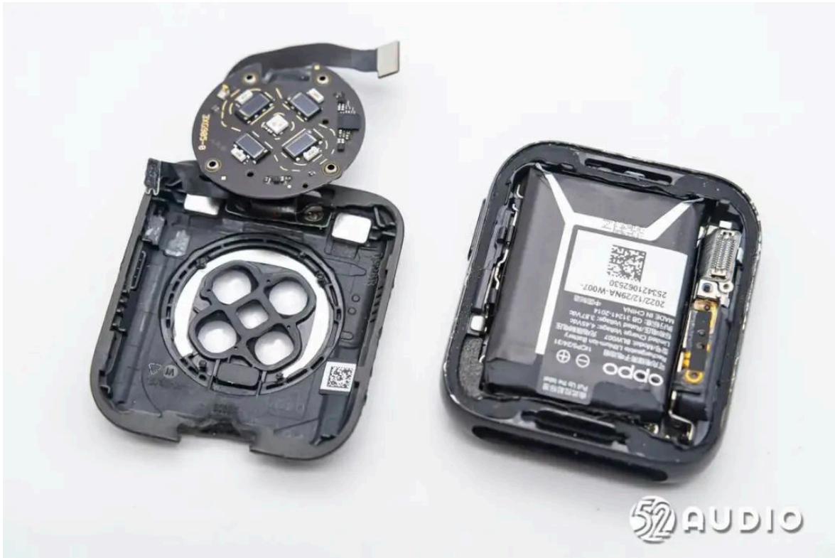
挑开排线连接器，取出传感器模组的小板。
