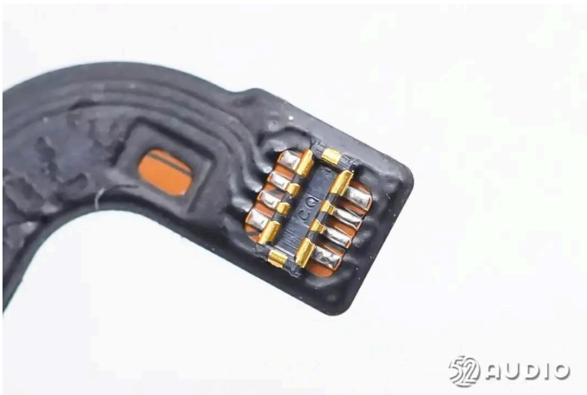
扬声器和振动马达模组排线与主板连接的BTB连接器公座特写。
