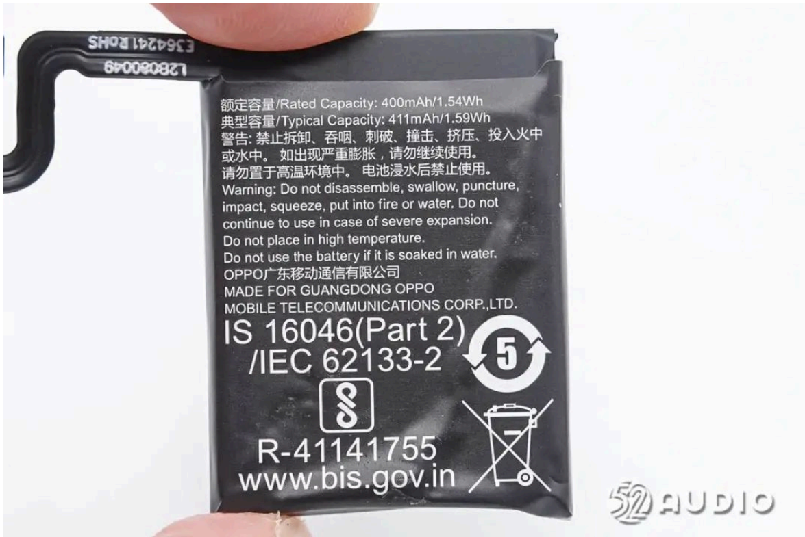
电池另外一侧信息一览，额定容量：400mAh/1.54Wh，典型容量：411mAh/1.59Wh，OPPO广东移动通信有限公司。
