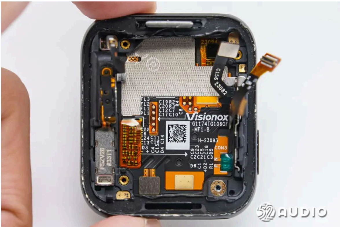
取出主板后，腔体内部结构一览，中框上通过金属支架固定有扬声器、振动马达、麦克风、气压计和功能按键等元器件。屏幕内侧丝印有供应商信息，来自Visionox维信诺。
