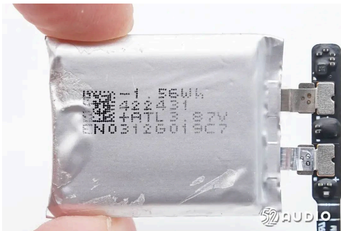
撕开电池外部绝缘保护，内部电芯上丝印信息，型号：422431，容量：1.56Wh，电压：3.87V，来自ATL新能源。
