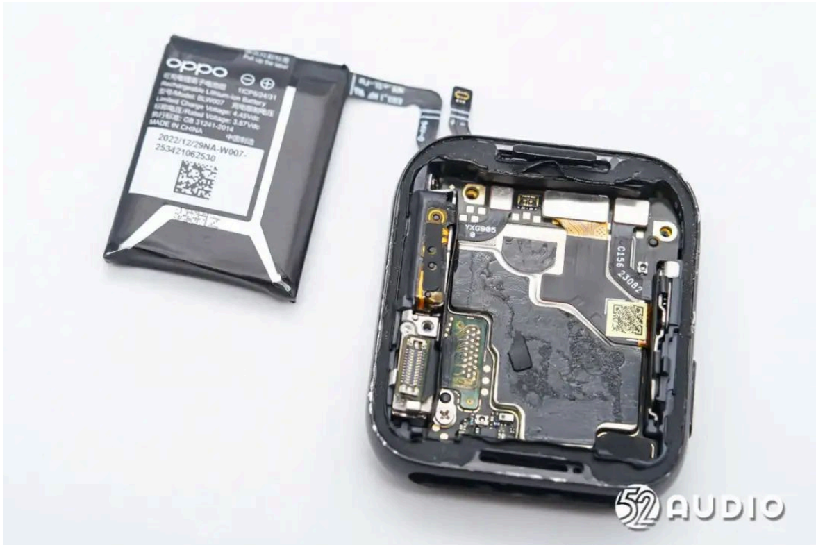
取掉金属压板，挑开连接器，取出电池单元。
