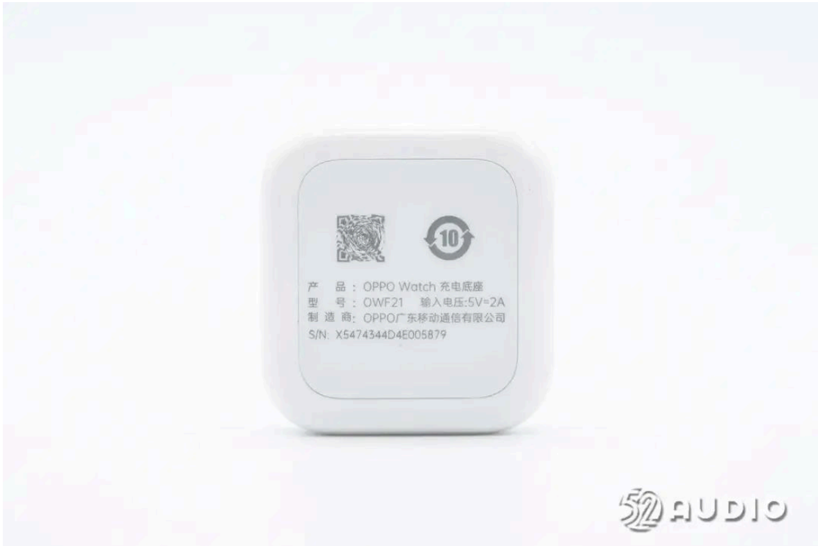
充电底座底部设置有橡胶垫防滑，印有产品信息，产品：OPPO Watch充电底座，型号：OWF21，输入电压：5V-2A，制造商：OPPO广东移动通信有限公司。
