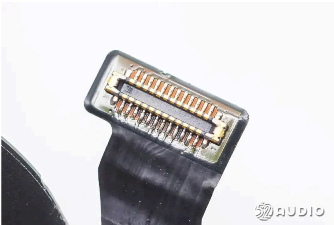
传感器模组小板排线与主板连接的BTB连接器公座特写。
