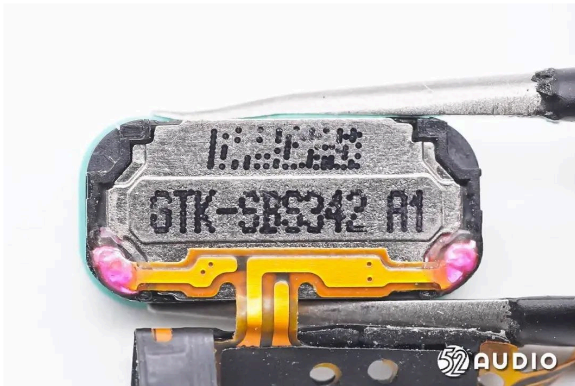
扬声器背面特写，丝印型号“GTK-SBS342 A1”，来自歌尔声学。
