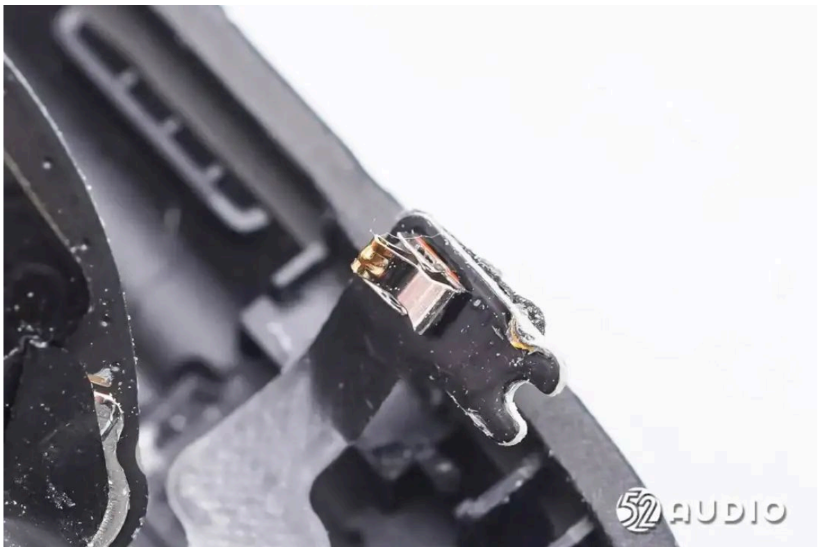
连接金属边框接地的金属弹片特写。
