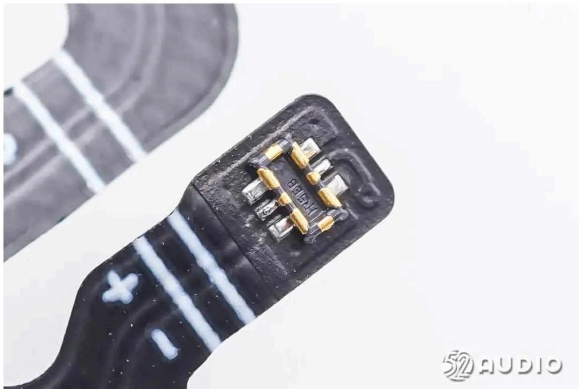
电池排线与主板连接的BTB连接器公座特写。
