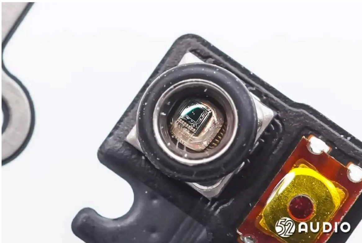
手表气压传感器特写，用于检测气压。
