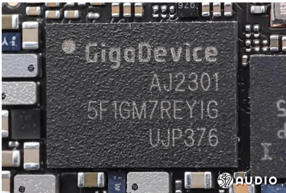
GigaDevice兆易创新GD5F1GM7REYIG SPI存储器，容量为1Gb，用于存储固件信息。
