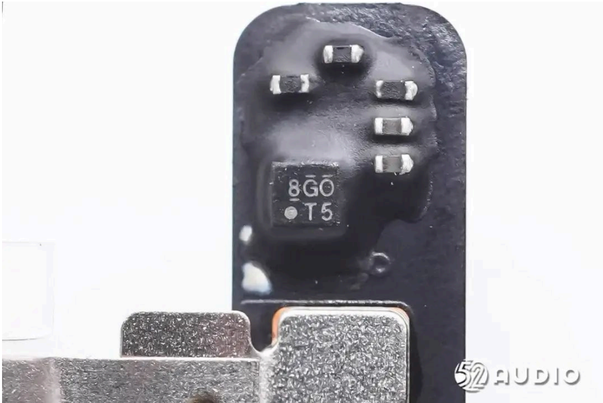
丝印8GO T5的锂电保护IC，负责电池过充电、过放电、过电流等保护。
