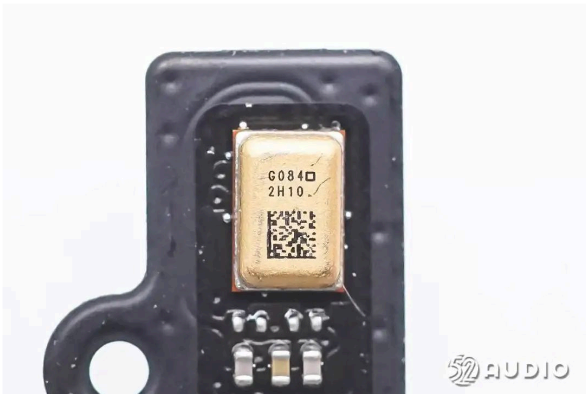
镭雕G084的MEMS麦克风，用于语音通话和语音助手功能拾音，来自歌尔微电子。
