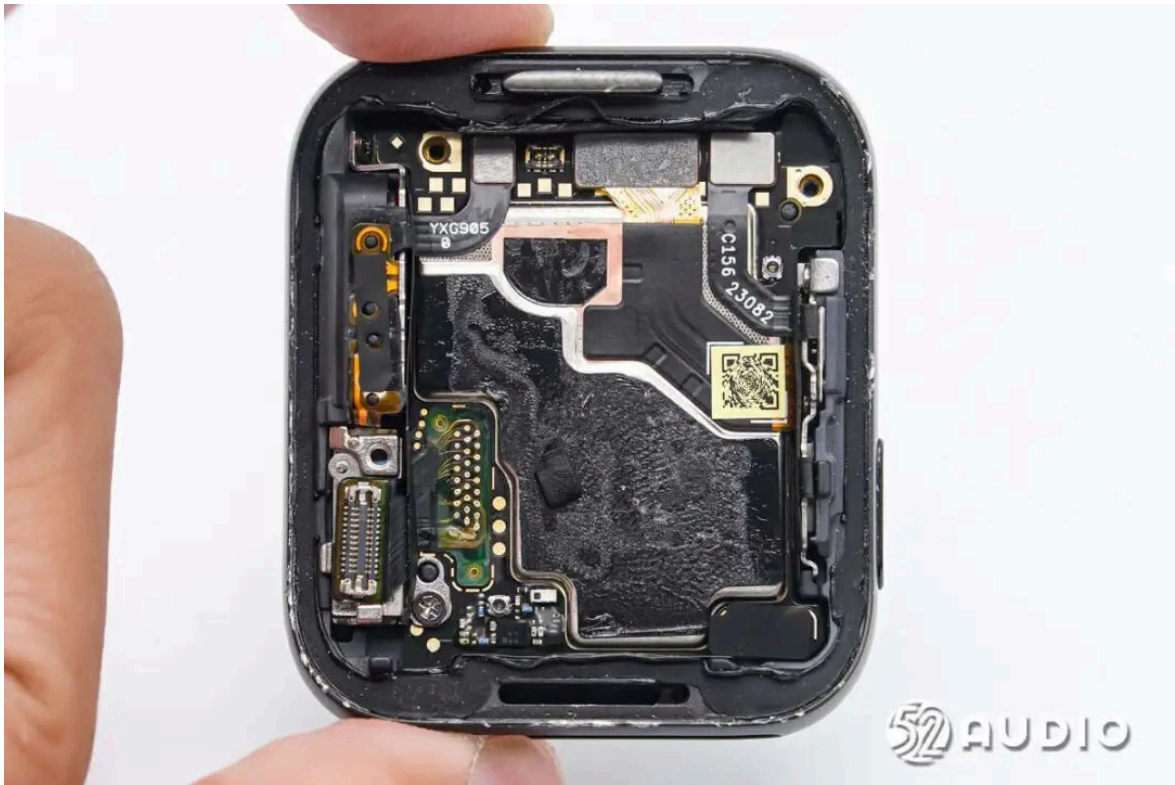
腔体内部主板单元结构一览，四周中框上的元器件均通过BTB连接器连接到主板。
