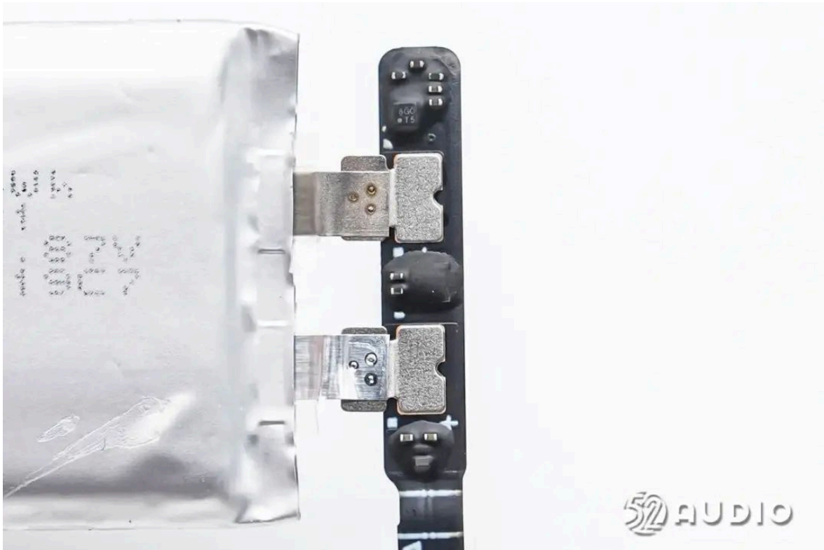
电池保护板一侧电路一览，元器件均涂有黑色硬质胶水防护。
