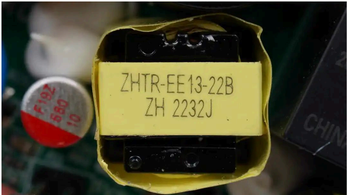
变压器采用EE13磁芯。
