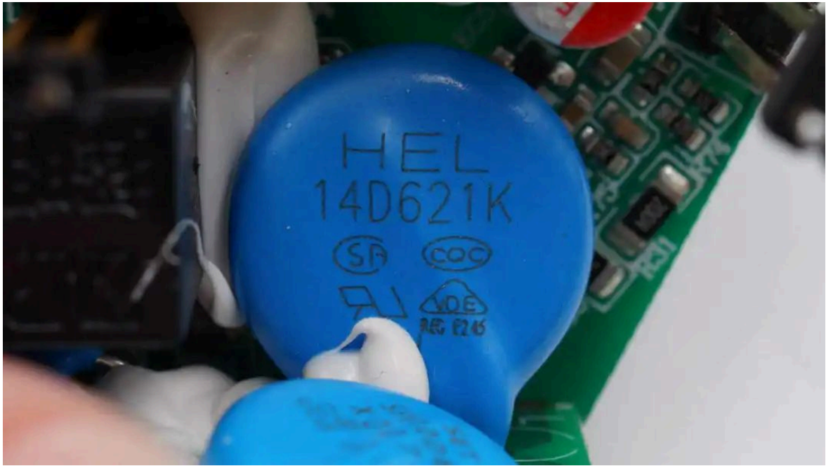
另一颗压敏电阻来自鸿志，型号14D621K，与气体放电管组合，共同用于浪涌保护。
