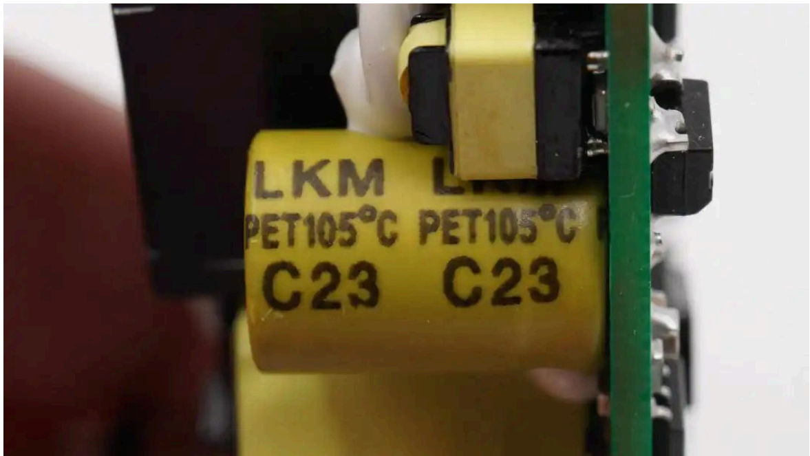
电容为LKM系列长寿命电解电容，规格为10 \mu F450V。
