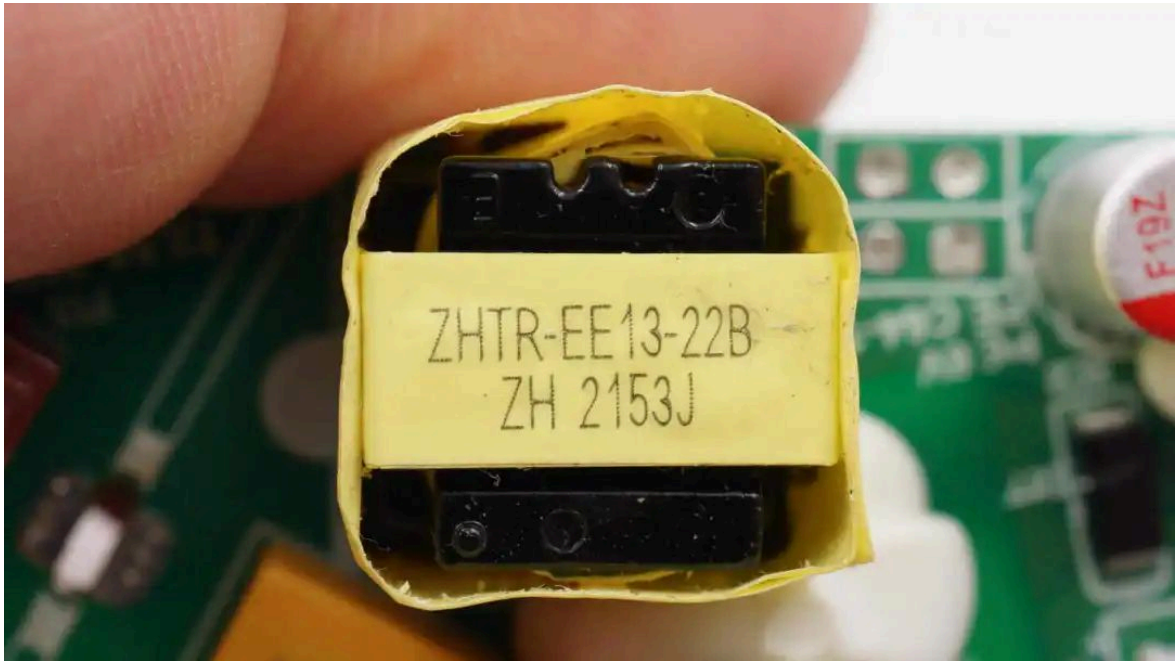
变压器采用EE13磁芯，缠绕胶带绝缘。
