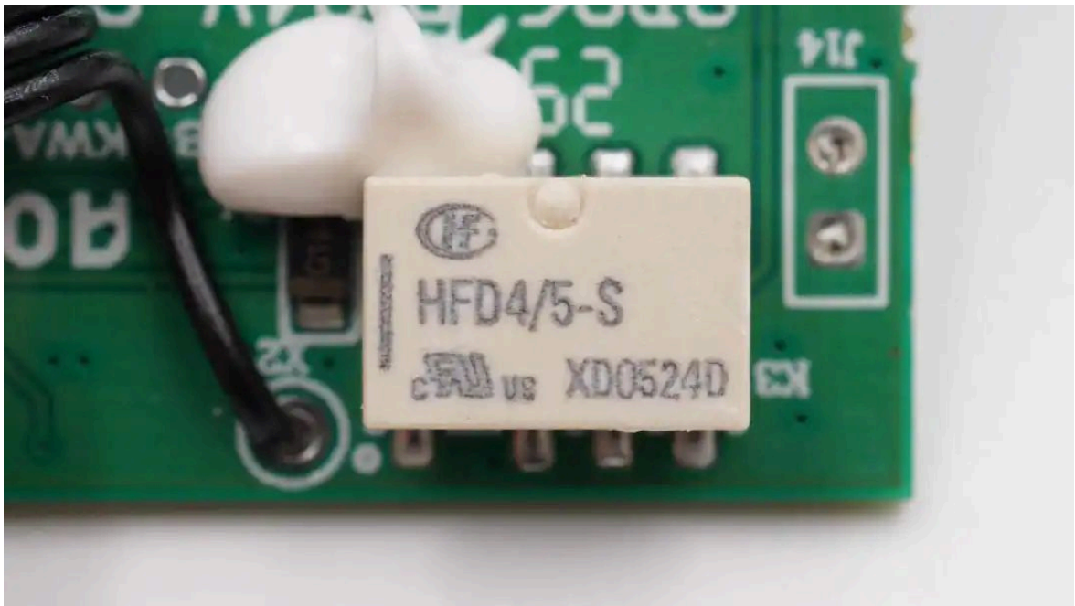
信号继电器来自宏发，为HFD4系列，线圈电压为5V，贴片焊接。
