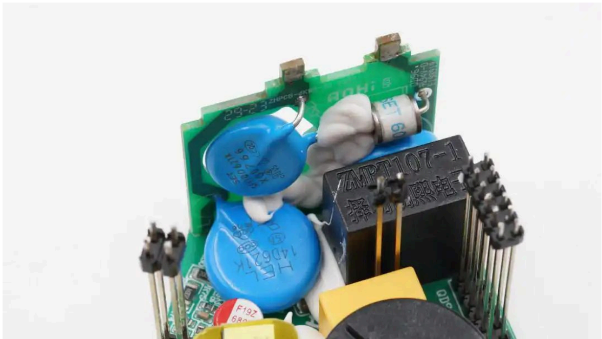
在垂直小板上焊接压敏电阻和气体放电管。
