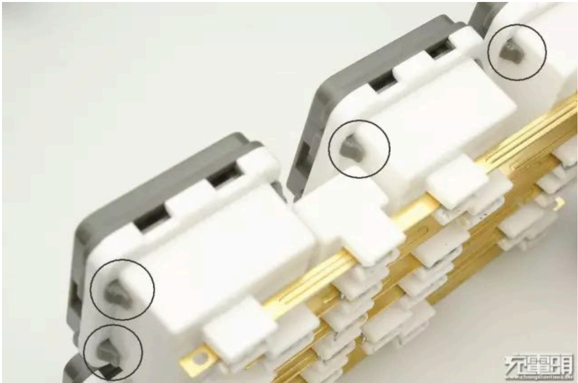
安全门模块通过较大的4脚插入较小的插套孔位后卡紧，形成一个新的整体。
